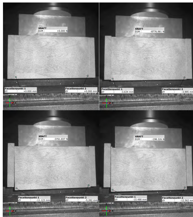
Abbildung 5.12: Push-Out-Zwischenriegel entgegen zur Einschubrichtung; Eiche-412a
