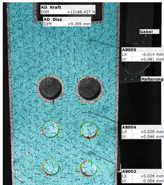
Abbildung 6.11: Die Hauptverformung und die Verschiebung der Holzlamellen um die Rissachse; 1431a
