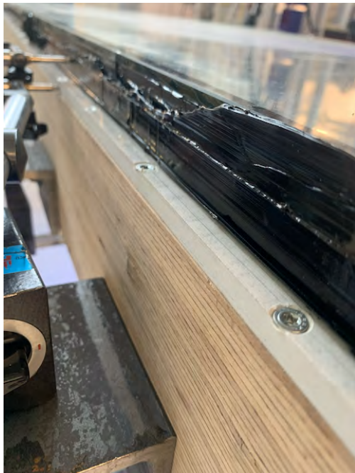
Abbildung 8.29: links: seitliches Ausreißen der Schrauben, rechts: Riss Druckpfosten
