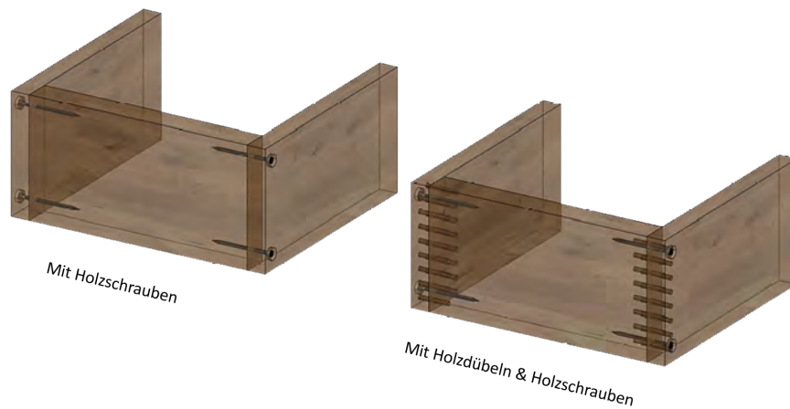
Abbildung 5.24: Prüfkörper mit Holzschrauben und ohne/mit Holzdübeln; Eiche-BSH
