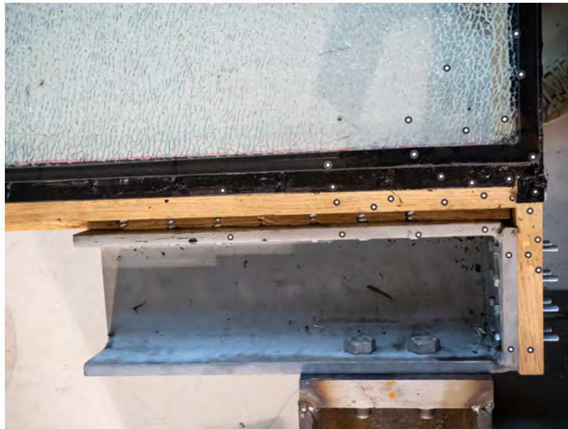
Abbildung 8.15: Großprüfkörper 1 / Unverschiebliches Lager nach dem Bruch
