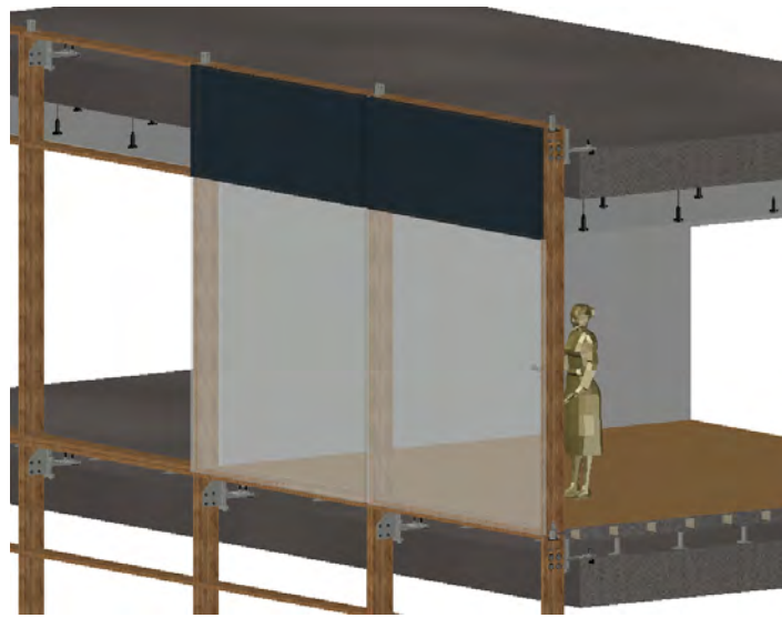
Abbildung 1.2: Holzelementfassade (vorgehängt, nicht aussteifend)
