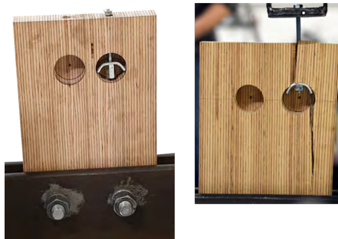
Abbildung 4.11: Der Prüfkörper (131g) aus dem Baubuche Paneel vor und nach dem Versuch
