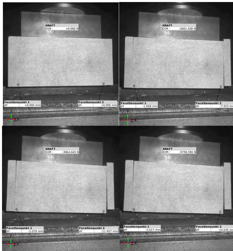
Abbildung 5.13: Push-Out-Zwischenriegel entgegen zur Einschubrichtung; Eiche-412c
