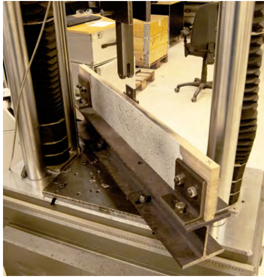
Abbildung 6.54: Lagerung der Proben in der Prüfmaschine - Geschossdeckenanschluss mit Schlossschrauben
