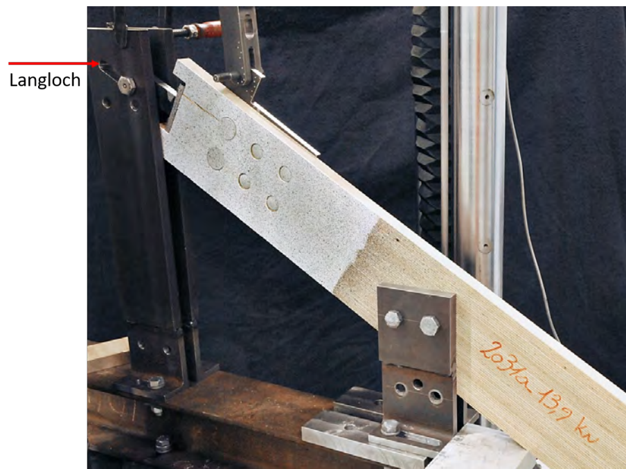
Abbildung 6.20: Versuchsaufbau; vorgebohrtes Langloch im Schenkel der großen Winkelprofile
